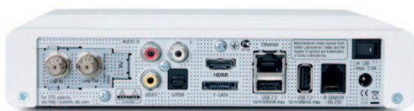
Prepojovacie porty sú na zadnej strane, šachty na kódovacie karty nájdete na boku prístroja
